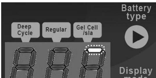
**Gel cell / SLA** – Väljer laddning för alla typer av gel- och SLA-batterier (SLA = slutna blybatterier).
