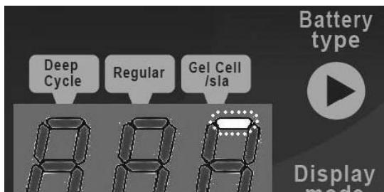
**Gel cell / SLA** – Latausvalinta kaikentyyppisille geeli- ja SLA-akuille (SLA = suljettu lyijyakku).
